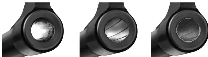
Läufe in verschiedenen Zuständen: v.li.. Barrel Fouling, intakter Lauf, verschmutzter Lauf
