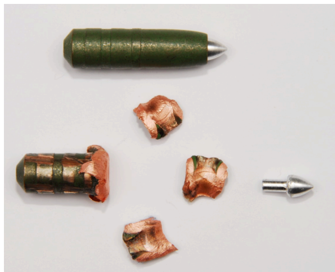
Original BRENNEKE TAG ® : Geschoss und Geschossreste mit drei gro- ßen Splintern und Aluspitze
