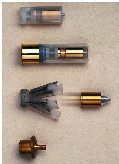
BRENNEKE SuperSabot: von oben: Geschoss mit Treibkäfig, Schnitt Patrone, geöffneter Käfig und Geschoss nach dem Abfeuern, aufgepilztes Geschoss im Ziel
